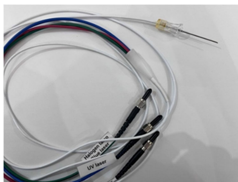
Рис. 5. Тонкоигольный волоконно-оптический зонд (предоставлен в НТЦ биомедицинской фотоники Орловского государственного университета имени И.С. Тургенева)
